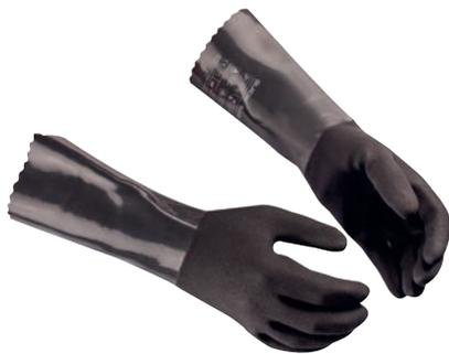
Guanto di protezione chimica per lavori di precisione e media intensità. Impregnato in due strati di miscela NBR/PVC a prova di liquido. Manichetta di sicurezza da 35 cm. Fodera in parammide lavorazione 15 aghi. Protezione antitaglio livello C. Protezione chimica di tipo A. Calore per contatto livello 1.
