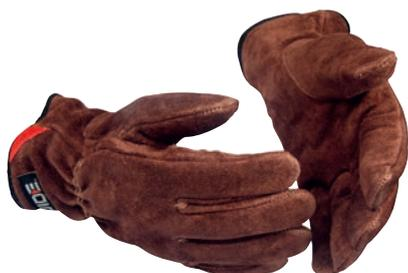
Guanto di alta qualità e dal taglio più corto realizzato in crosta di cuoio con rivestimento idrorepellente e resistente agli oli. Il guanto è completamente foderato in cotone e tutte le cuciture sono realizzate in filo di Kevlar resistente al calore. Lunghezza 26 centimetri.
