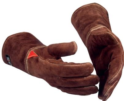
Guanto per saldatura di alta qualità, modello lungo, realizzato in pelle bovina con trattamento superficiale repellente ad acqua e oli. Il guanto presenta una fodera integrale in cotone e tutte le cuciture sono realizzate in filato di Kevlar resistente al calore. Lunghezza 32 cm. Approvato a norma EN 12477 tipo A.
