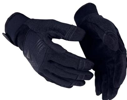
Guanto nero in pelle sintetica con protezione alla penetrazione, basato sulla nostra esclusiva "CPN-technology". Un sottile tessuto metallico nell'interno della mano protegge da aghi e altri oggetti affilati – 4 strati nella coppa e 2 strati che coprono dai lati inferiori delle dita alla zona delle unghie. Manichetta di facile regolazione con nastro velcro. Protezione antitaglio di livello F.
