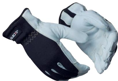
Guanto molto comodo in pelle di capra con dorso in fibra meta-aramidica intrinsecamente resistente al calore. Realizzato per gli ambienti difficili dove sussiste il rischio di arco elettrico e calore. È realizzato con doppie cuciture resistenti al calore e l'interno della mano è foderato in para-aramide che assicura inoltre una protezione antitaglio di livello B. I bordi esterni dell'interno della mano sono dotati di rinforzi per maggiore protezione. Certificato per livello 1 ATPV, CAL 6
