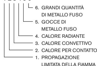
Questa norma specifica i requisiti e i metodi di prova per i guanti che devono fornire protezione contro il calore e/o il fuoco. I numeri indicati accanto al pittogramma indicano le prestazioni del guanto per ogni test nello standard. Maggiore è il numero, migliore è il livello di prestazioni.
