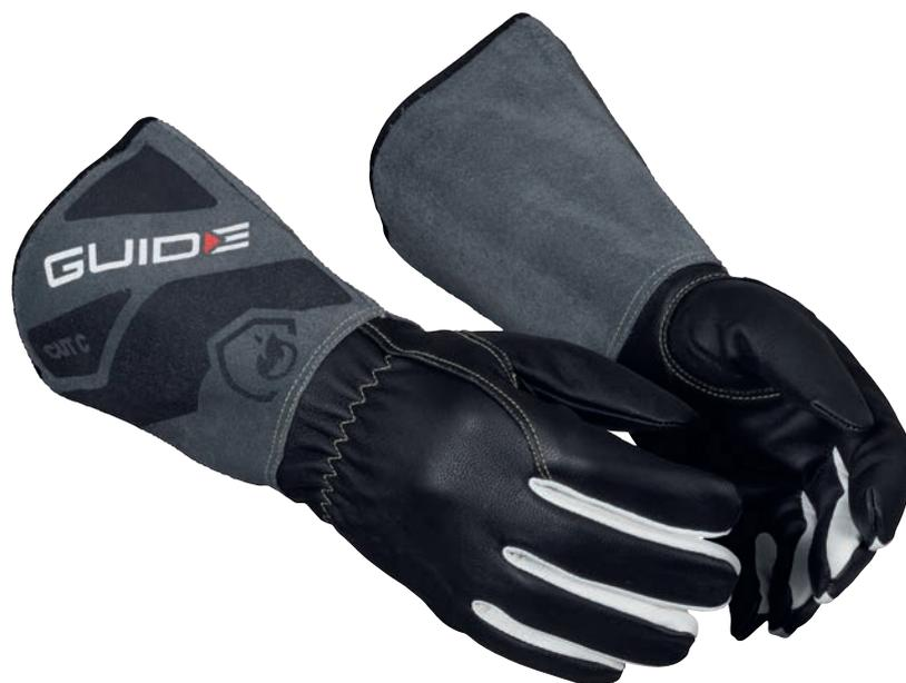
Guanto per saldatura con protezione antitaglio livello C, realizzato in pelle di capretto pieno fiore, morbida ma resistente. Adatto per saldatura TIG. La manichetta è realizzata in crosta di pelle di mucca con una sottile garza di cotone all'interno e tutte le cuciture sono realizzate in kevlar resistente al calore. Le pareti laterali delle dita offrono la maggiore destrezza possibile e una sensazione di comfort. Conforme alle norma EN12477 Tipo B
