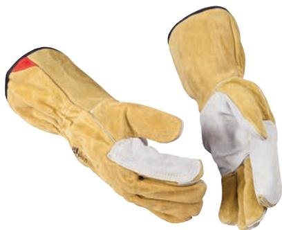
Guanto per saldatura altamente resistente all'usura in pelle bovina, progettato per la saldatura MIG e MAG. Foderato in cotone con fodera supplementare per il dorso e cuciture in filato di Kevlar resistente al calore. Modello lungo, 34 cm, disponibile in due versioni. Il numero articolo 223501677 è un set di 2 guanti sinistri. Approvato a norma EN 12477 tipo A.
