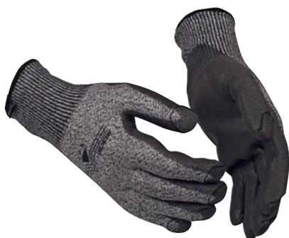
Guanto con protezione alla penetrazione, palmo immerso in PU basato sulla nostra esclusiva "CPN-technology". Un sottile tessuto metallico nell'interno della mano protegge da aghi e altri oggetti affilati – 4 strati nella coppa e 2 strati che coprono dai lati inferiori delle dita alla zona delle unghie. Per una protezione supplementare, anche il dorso è dotato di materiale di protezione antitaglio. Protezione antitaglio di livello F.
