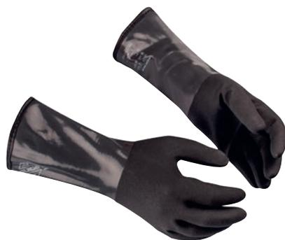
Guanto di protezione chimica per lavori di precisione e media intensità in ambienti freddi. Impregnato in due strati di miscela NBR/PVC a prova di liquido. Manichetta di sicurezza da 35 cm. Fodera in nylon lavorazione 18 aghi combinata con una fodera invernale in acrilico per ambienti freddi. Protezione chimica di Tipo A. Calore per contatto livello 2.
