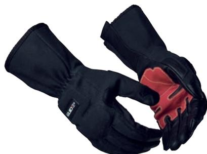
Guanto per saldatura in pelle di bufalo, progettato per la saldatura MIG. Il dorso è realizzato in fibra meta-aramidica resistente al calore. Interno della mano, pollice e indice con rinforzi in pelle di bufalo e doppie cuciture resistenti al calore. Dotato di manichetta lunga per una maggiore protezione del braccio.
