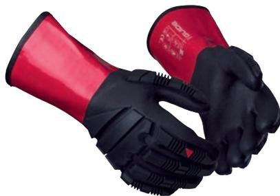
Guanto di protezione dai prodotti chimici per condizioni offshore. Immersione a tre strati in miscela di nitrile/PVC con tenuta ai liquidi. Adatto agli ambienti dove sono presenti determinate sostanze chimiche. Il guanto presenta paracolpi sul dorso e protezione antitaglio di livello C, è approvato per calore per contatto livello 2 e protezione dai prodotti chimici a norma ISO 374-1 tipo A
