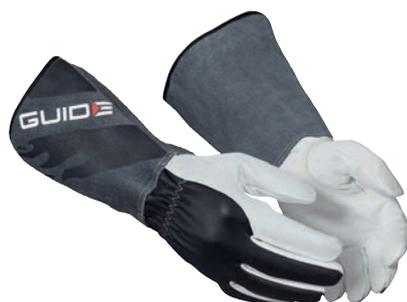
Guanto per saldatura sottile realizzato in resistente e morbida pelle di capretto pieno fiore. Adatto per saldatura TIG. La manichetta è realizzata in crosta di pelle di mucca con una sottile garza di cotone all'interno e tutte le cuciture sono realizzate in kevlar resistente al calore. Le pareti laterali delle dita offrono la maggiore destrezza possibile e una sensazione di comfort. Conforme alle norma EN12477 Tipo B
