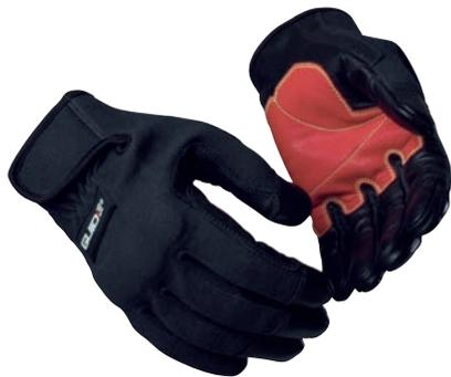
Guanto di protezione dal calore in pelle di bufalo. Il dorso è rinforzato con fibra meta-aramidica resistente al calore. Interno della mano, pollice e indice con rinforzi in pelle di bufalo e doppie cuciture resistenti al calore. Polsino di facile regolazione e chiusura con nastro velcro. Protezione antitaglio di livello B.
