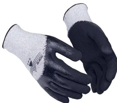
Guanto con protezione alla penetrazione in nitrile, con nocche rivestite e palmo a doppia spalmatura, basato sulla nostra esclusiva "CPN-technology". Un sottile tessuto metallico nell'interno della mano protegge da aghi e altri oggetti affilati – 4 strati nella coppa e 2 strati che coprono dai lati inferiori delle dita alla zona delle unghie. Protezione antitaglio di livello F.
