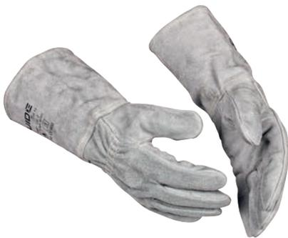
Guanto per saldatura resistente all'usura, foderato e altamente robusto, progettato per i lavori di saldatura più gravosi – MIG e MAG. Il guanto, realizzato in pelle bovina resistente all'usura, protegge dal calore per contatto. Tutte le cuciture sono realizzate in filato di Kevlar resistente al calore.
