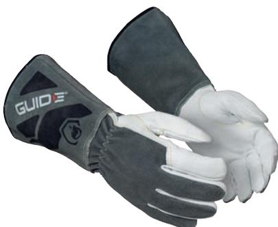
Guanto per saldatura realizzato in resistente e morbida pelle di capretto pieno fiore sul palmo e crosta di pelle di mucca sul dorso della mano. Adatto per saldatura TIG. La manichetta è realizzata in crosta di pelle di mucca con una sottile garza di cotone all'interno e tutte le cuciture sono realizzate in kevlar resistente al calore. Le pareti laterali delle dita offrono la maggiore destrezza possibile e una sensazione di comfort. Conforme alle norma EN12477 Tipo B
