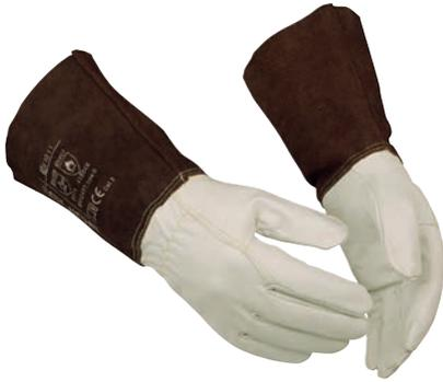
Guanto per saldatura, modello più semplice, ultrasottile e non foderato. Dotato di palmo e dorso in pelle di capra pieno fiore comoda e resistente all'usura e manichetta in pelle sintetica, è adatto solo alla saldatura TIG. Tutte le cuciture sono realizzate in filato di Kevlar resistente al calore.
