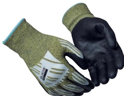
Guanto da lavoro comodo e senza cuciture, con interno della mano rivestito in bopolimero, realizzato in materiali che lo rendono ideale per gli ambienti difficili dove sussiste il rischio di arco elettrico e calore. Il guanto presenta una protezione antitaglio di livello D ed è testato per calore per contatto livello 1. Certificato per livello 2 ATPV, CAL 10,3.
