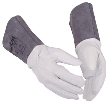
Guanto per saldatura ultrasottile, non foderato, con ottima sensibilità delle dita, progettato per la saldatura TIG. Manichetta in pelle suina, palmo e dorso in pelle di capra pieno fiore comoda e resistente all'usura. Tutte le cuciture sono realizzate in filato di Kevlar resistente al calore.
